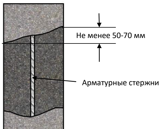
Рисунок 3. Подготовленная поверхность дефекта (в разрезе).
